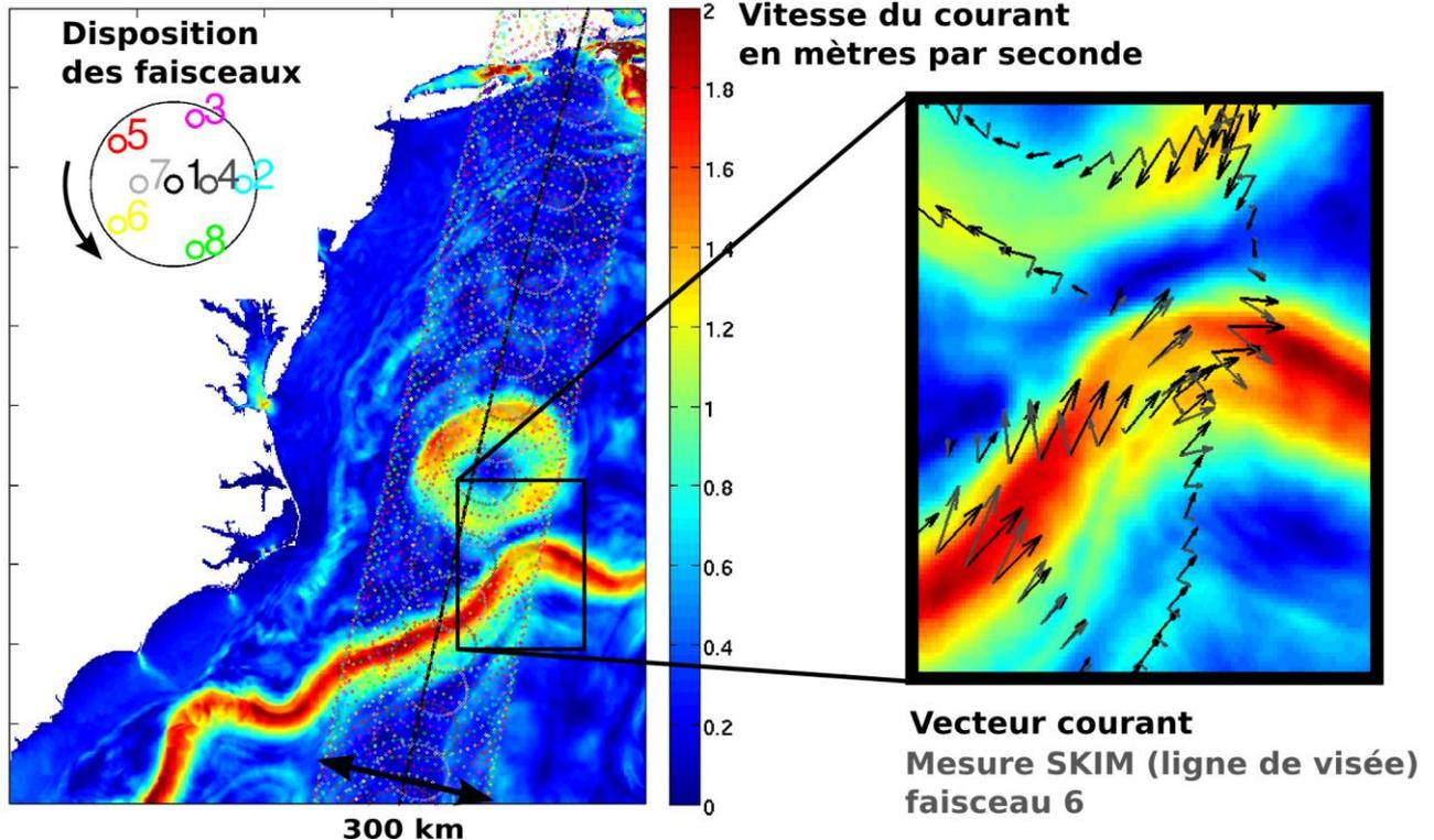
Illustration du principe de mesure de SKIM : Carte de courant autour du Gulf Stream calculée avec un modèle numérique. Les spirales montrent les traces au sol des faisceaux SKIM. A droite, les vecteurs courant dans la direction de visée (en vert), qui sont les projections du vecteur courant (noir). [https://youtu.be/xtgAp\\_7EmAc](https://youtu.be/xtgAp_7EmAc)
