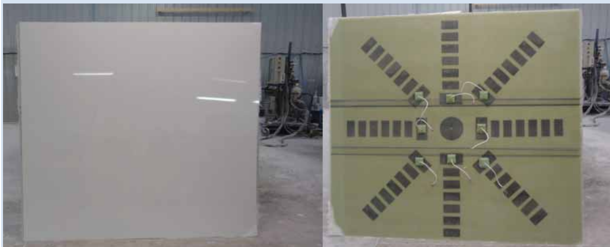
Fabrication du toit du démonstrateur (toit de camping-car) avec la face extérieure gel-coatée (en blanc) de l'élément de toit intégrant les 8 antennes en matériaux composites © projet Samcom
