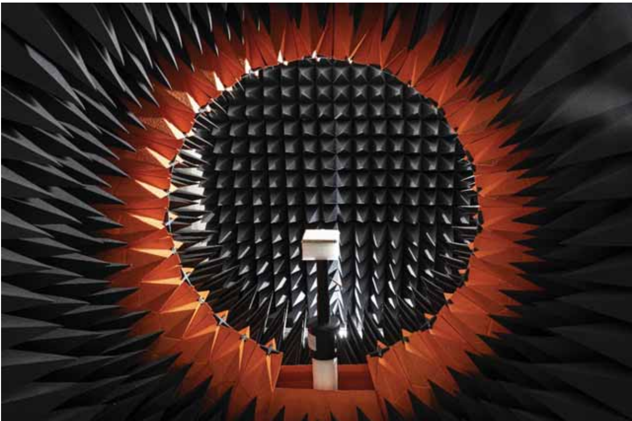
Antenne en matériau composite placée sur un mât au sein de la base de mesure en champ proche électromagnétique © Jean-Claude MOSCHETTI / IETR / CNRS Photothèque
